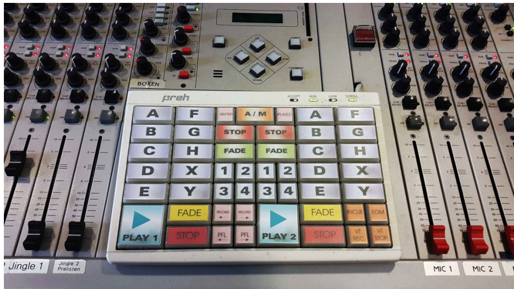
Abbildung 27: Mischpult mit zusätzlichem Bedienfeld bei Radio Freequenns
