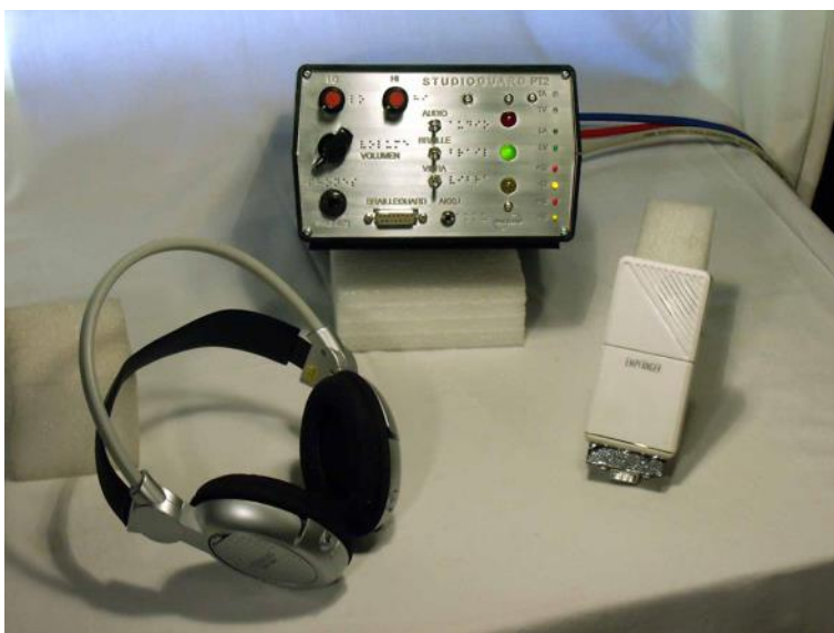
Abbildung 37: Studioguard Prototyp 2 mit Vibrationseinheit und Funkkopfhörer
