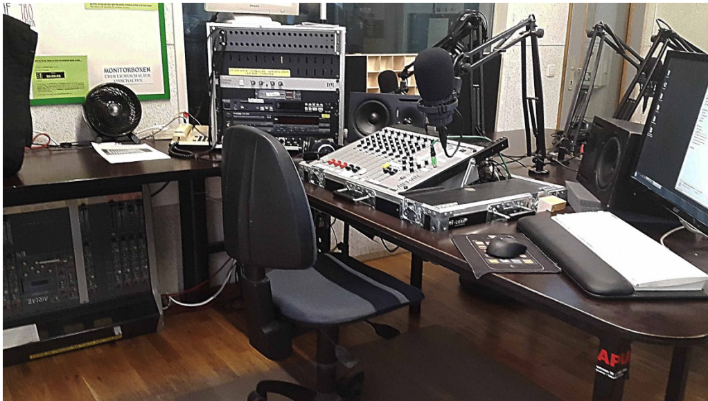
Abbildung 30: Moderationstisch mit Mischpult und Mikrofonarmen bei Radio FRO
